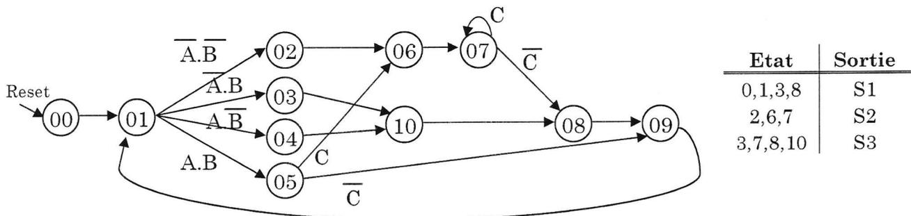
L'objectif général est d'appliquer la **synthèse micro-programmée** pour transformer cet automate en un circuit. Il est rappelé que cette méthode de synthèse conduit à l'élaboration d'un « séquenceur » (cadencé à la fréquence d'une horloge CLK) couplé à une « mémoire morte ROM ».
